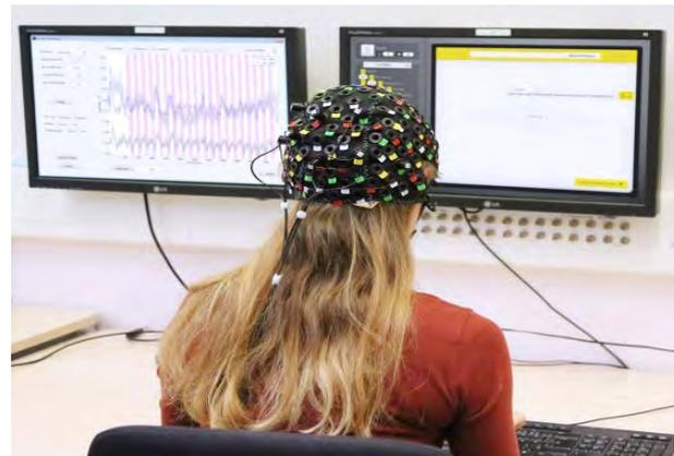
Gehirn-Computer-Schnittstelle zur Emotionserkennung (Quelle: Fraunhofer IAO)
