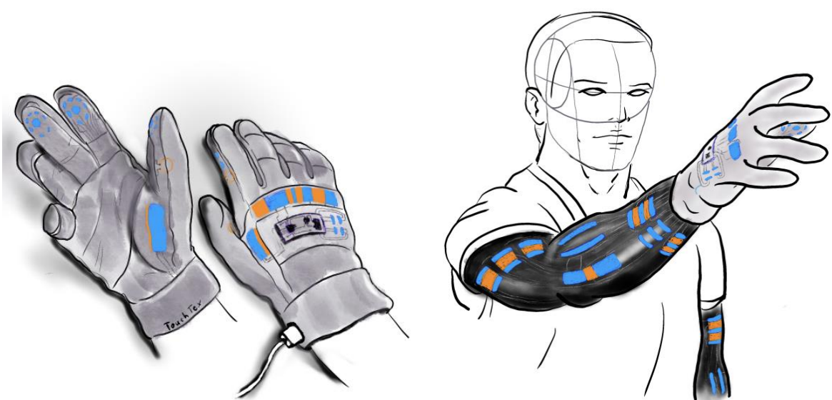
Abbildung 1. Skizze des TouchTex-Systems bestehend aus Gloves (links) und Sleeves (rechts) mit integrierten Funktionselementen: Sensoren (orange) und punktuelle bzw. flächige gedruckte Aktuatoren (blau).
