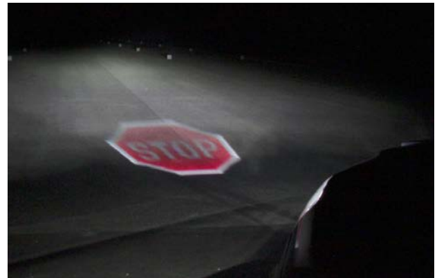
Erste Funktionsumsetzung der Lichtprojektion eines Stoppschildes (Quelle: VW AG)
