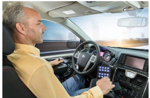
Fahrzeugführung mit Lenkgesten (Quelle: PARAVAN GmbH)
