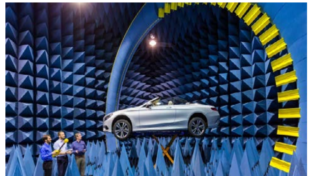
Test- und Validierungsplattform für komplexe Sensoriksysteme zur Umfelderkennung hochautomatisierter Fahrzeuge (Quelle: TU Ilmenau)
